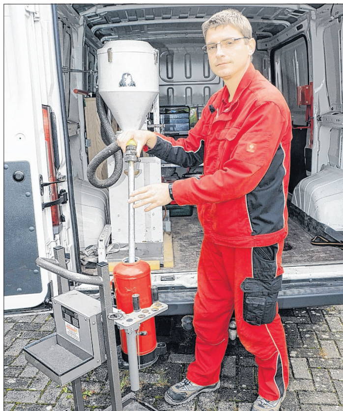
Seine Werkstatt hat Tobias Machon praktisch immer dabei, wenn er mit seinem Wagen unterwegs ist. So kann er gleich vor Ort Feuerlöscher entleeren und mit frischem Löschpulver befüllen.
