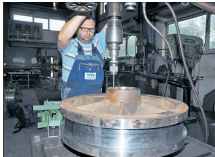
Joachim Krettek bearbeitet am Bohrwerk das Laufrad für einen Kran.
